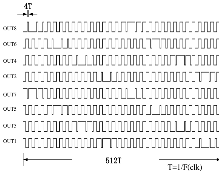
GC7615B 容栅传感器驱动波形图
